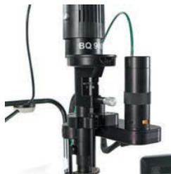
El 5G incluye todas las características de los modelos anteriores, y se puede montar en una amplia gama de lámparas de hendidura, tanto nuevas como existentes. Además, el diseño permite acoplarle LIO y endosondas.
