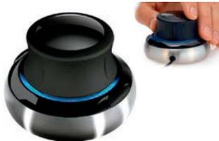
Nuestro Mando Inteligente patentado, hace funcionar el láser Valon rápida y fácilmente. Puede ser utilizado para ajustar los parámetros con los que más frecuentemente se trabaja, como la potencia del láser, tamaño del patrón y la rotación, sin necesidad de mirar el monitor. Esta opción reduce significativamente el tiempo de tratamiento y aumenta la capacidad de enfoque.
