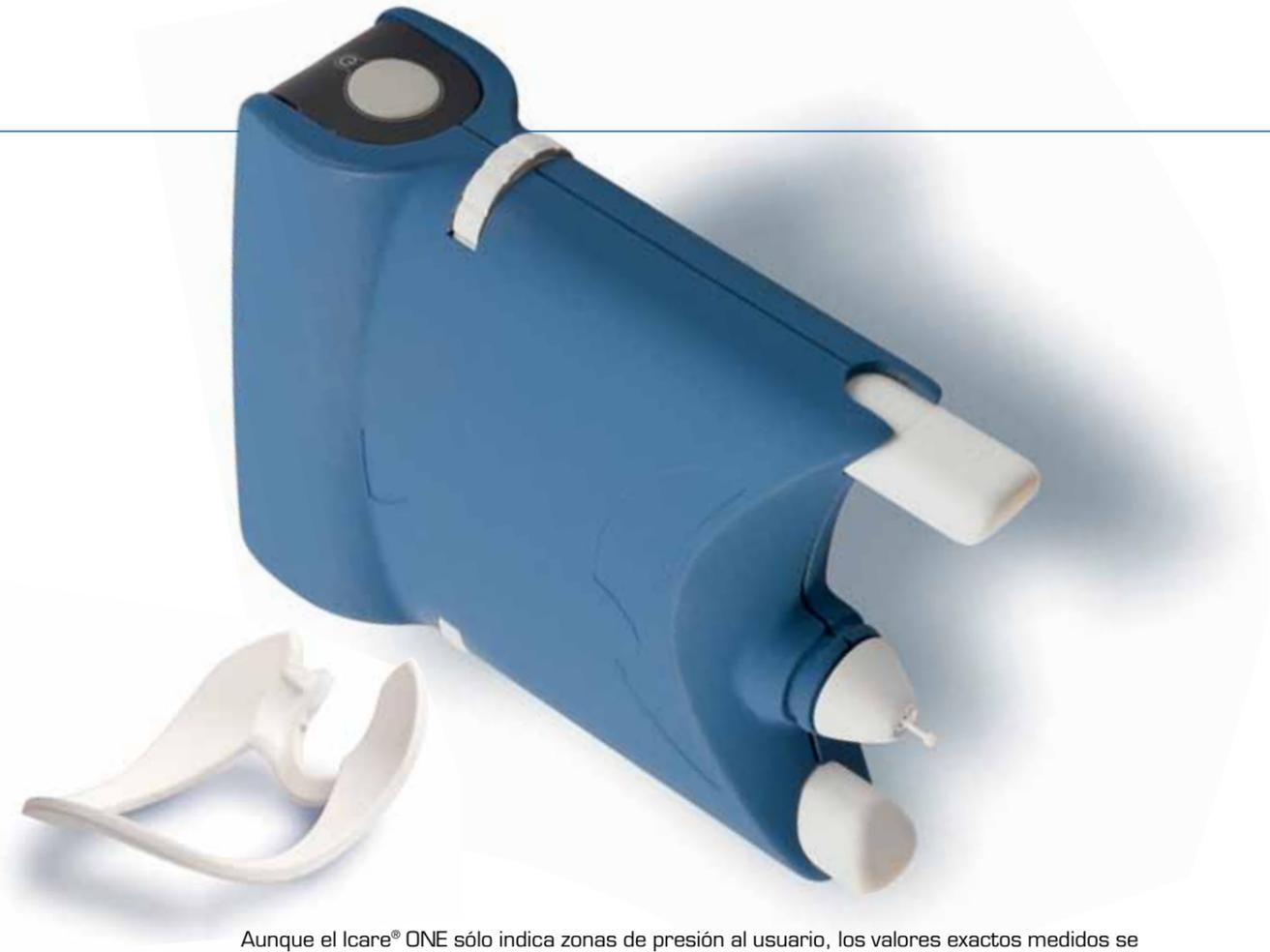
Aunque el Icare® ONE sólo indica zonas de presión al usuario, los valores exactos medidos se almacenan en la memoria del tonómetro para un acceso sencillo. Los datos contienen una medición exacta, su calidad y la fecha con la hora de cada medición individual. El historial de todas las mediciones puede transferirse a través de un cable USB a un ordenador a través de nuestro software específico Icare® LINK.
